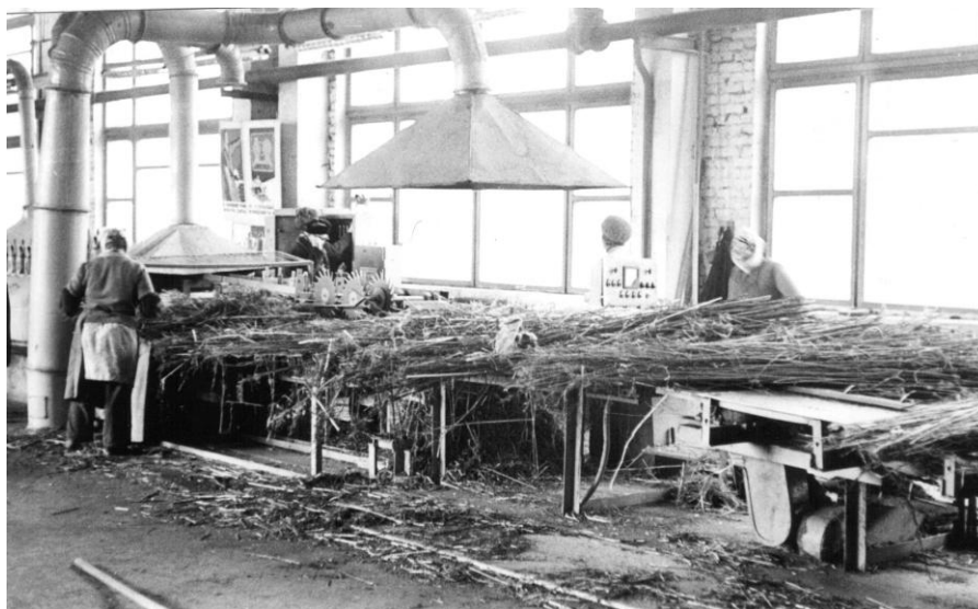
Рисунок 1 - Выделение крупного сора при формировании слоя стеблей льна.
